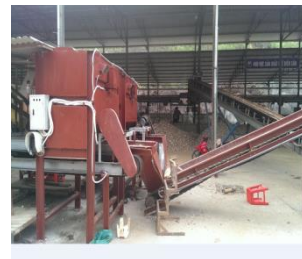
Hình 1. Thiết bị cấp liệu- tách đất- thái khúc- chuyển liệu vào bin sấy
