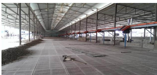
Hình 2. Hệ thống cấp liệu tự động vào bin sấy và máy sấy sàn phẳng
