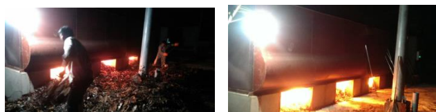
Hình 2. Nhiên liệu đốt và quá trình cháy nhiên liệu trong buồng đốt
