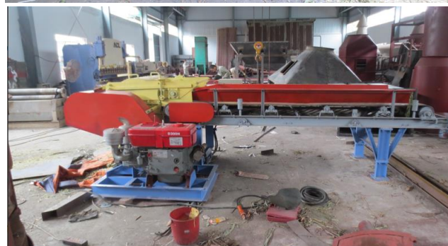
Hình 2. Một số hình ảnh chạy thử máy băm thái tại xưởng RIAM
