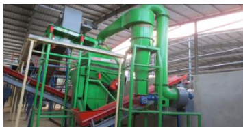
Hình 5. Thiết bị phân loại tỷ trọng được lắp đặt tại nhà máy
