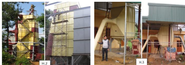
Hình 2 & 3. Hai kiểu tháp sấy tiêu biểu (quy mô- công nghiệp và hộ gia đình).
