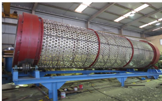
Hình 2. Hệ thống thiết bị Sàng phân loại - xé túi sơ cấp được chế tạo tại xưởng RIAM
