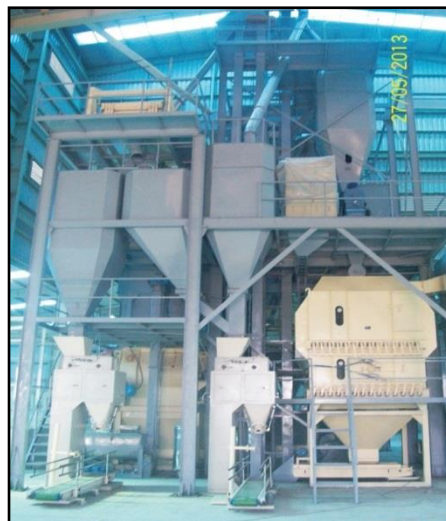
H.1 - Dây truyền thiết bị chế biến thức ăn chăn nuôi: dạng bột và viên, các mức năng suất 3-5 tấn/giờ; 8-10 tấn/giờ; 15-20 tấn/giờ
