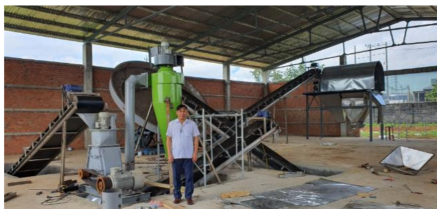
Hình 2. Nhà máy khi lắp đặt thiết bị vận chuyển và máy nghiền
