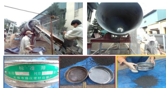
Hình 1. Chạy khảo nghiệm trồng tạo viên theo công nghệ sản xuất phân bón hữu cơ khoáng có hàm lượng đạm cao
