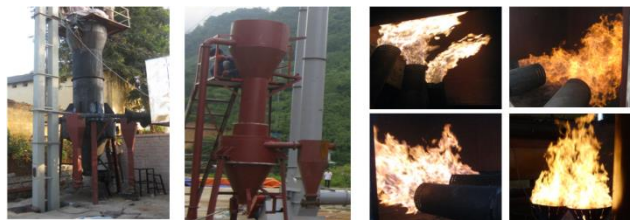
Hình 6. Một số mẫu lò khí hóa liên tục sử dụng phụ phẩm nông-, lâm nghiệp và các hình ảnh ngọn lửa khi đốt khí GAS (Syngas) tạo ra được từ lò khí hóa khí sử dụng để sấy nông sản, đốt nồi hơi.
