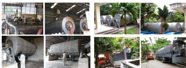
Hình 3. Một số hình ảnh về máy sấy dạng trống: chế tạo tại xưởng của Viện RIAM; chuyển máy đi lắp và lắp đặt hoàn thiện cho khách hàng
