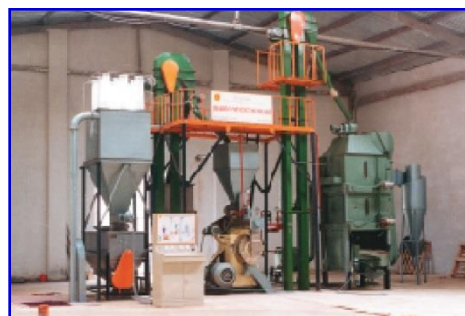
H.2 - Tổ hợp thiết bị chế biến thức ăn chăn nuôi: dạng bột và viên, mức năng suất: 1,0-1,5 tấn/giờ
