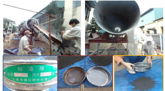
Hình 1. Chạy khảo nghiệm trồng tạo viên theo công nghệ sản xuất phân bón NPK có hàm lượng đạm cao
