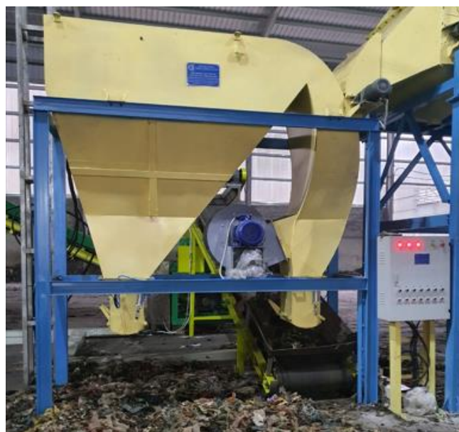
Hình 3. Cụm thiết bị tách/phân loại ni lông và hữu cơ
