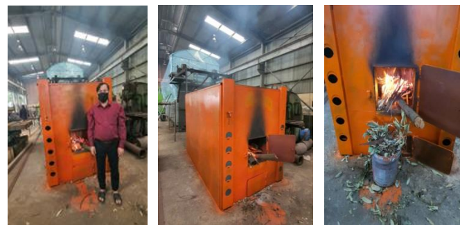
Hình 3. Hệ thống thiết bị lò đốt không ống khói tiết kiệm năng lượng cấp nhiệt cho HT xử lý phân chế tạo tại RIAM
