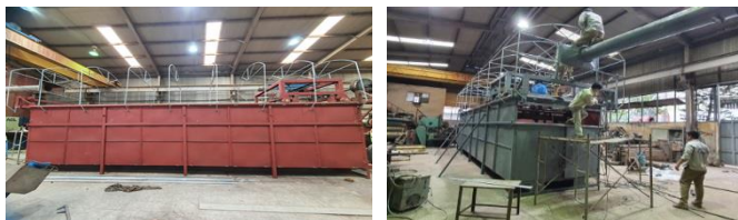
Hình 1. Hệ thống thiết bị buồng ủ được chế tạo, lắp ráp tại RIAM
