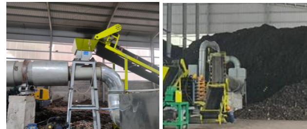
Hình 3. Hệ thống thiết bị sấy hỗn hợp rác thải SH để ép viên RDF
