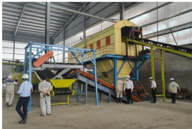
Hình 1. Hệ thống thiết bị Sàng phân loại - xé túi sơ cấp và tuyển từ
