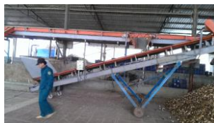
Hình 3. Hệ thống thiết bị chuyển liệu vào bin sấy và chiều cao lớp liệu
