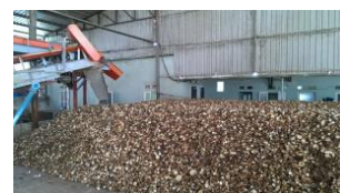
Hình 3. Hệ thống thiết bị chuyển liệu vào bin sấy và chiều cao lớp liệu
