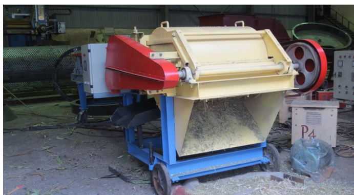
Hình 1. Thiết bị máy băm thái đã được chế tạo tại xưởng của RIAM
